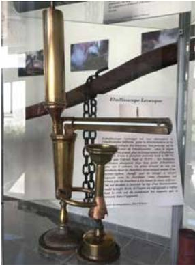
La distillation permet également de mesurer le degré alcoolique des vins ou leur acidité volatile grâce à des **mini alambics** permettant d'extraire l'alcool ou les acides volatiles, ou des **ébulliomètres/ébullioscopes** mesurant le point d'ébullition des solutions alcooliques.
