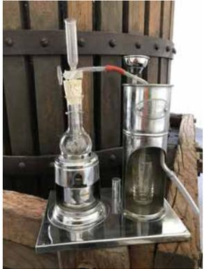
alambic pour l'extraction de l'acidité volatile du vin
